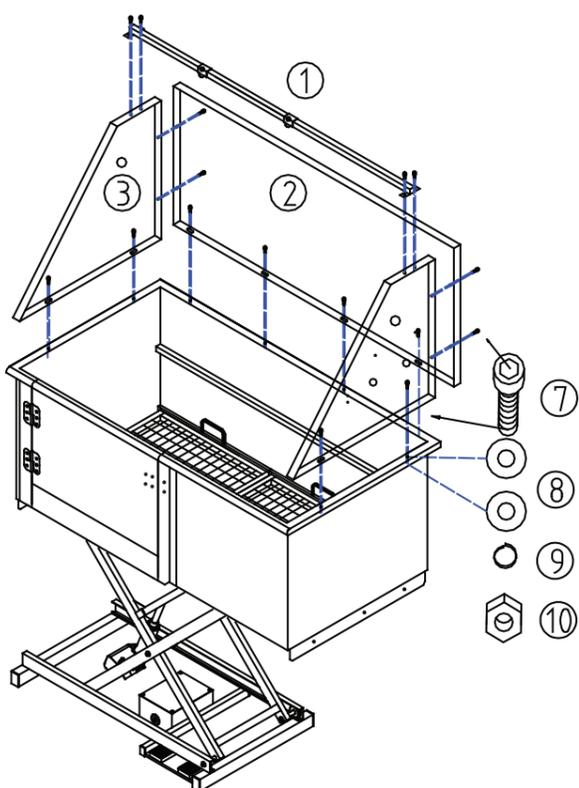
**1. Verschrauben Sie die Rückwand (2) mit der Grundwanne (4). Verwenden Sie je eine Schraube (7) zwei Beilagscheiben (8) Federscheibe (9) und eine Mutter (16) je Loch.**
